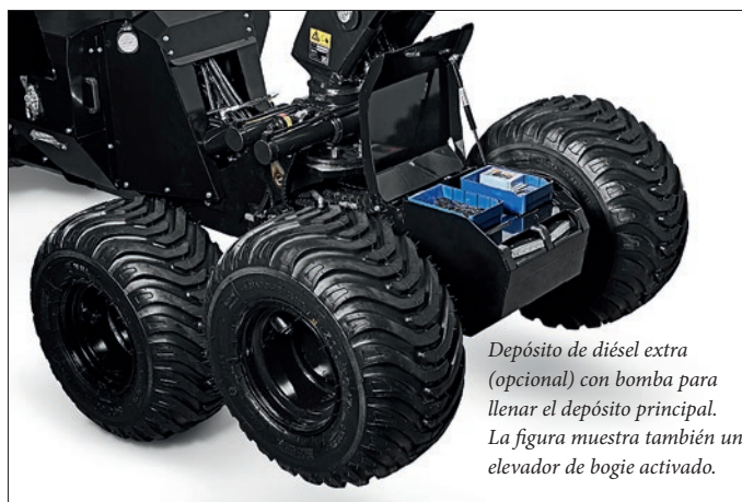
Amplio compartimiento para herramientas, espada y diésel extra (o para recipientes de líquido de tratamiento de tocones, como en la figura).
