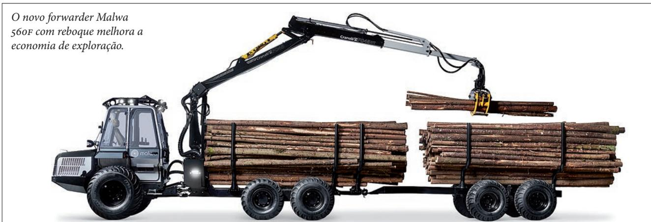
Forwarder para florestas sem espaçamentos abertos, com uma capacidade de carga de 5 500 kg ou 9 000 kg equipado com reboque.
